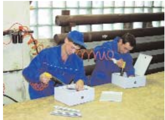
Современные пневматические шуруповёрты максимально ускоряют процесс окончательной сборки корпусов.
