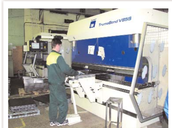
Листогибочный пресс с ЧПУ TRUMPF TrumaBend может придать полученным заготовкам любую необходимую форму с высокой точностью.
