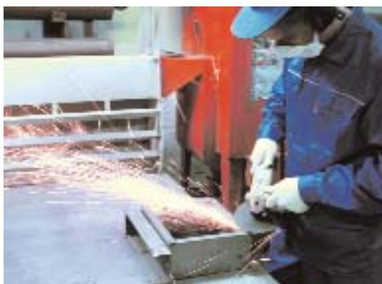
Перед покраской все углы и места сварки тщательно шлифуются.
