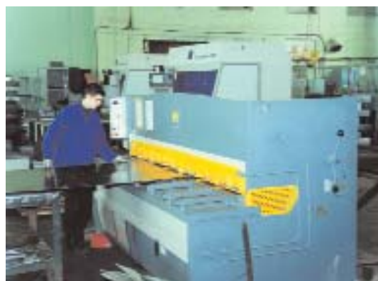
Гильотинные ножницы с ЧПУ НАСО (Бельгия) максимально точно выполняют раскрой листового металла.
