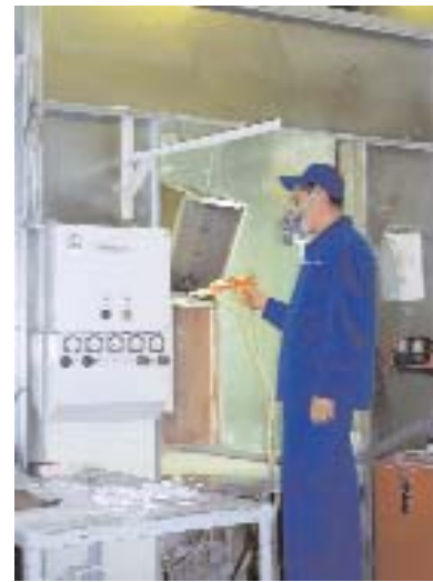
Обезжиренные специальным раствором корпуса окрашиваются порошковой краской лучших западных производителей в вентилируемых боксах.
