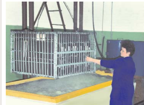
Перед покраской металлокорпуса проходят химическое обезжиривание в ваннах со специальным раствором.
