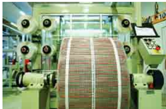
Автоматическая линия по производству нагревательных матов
