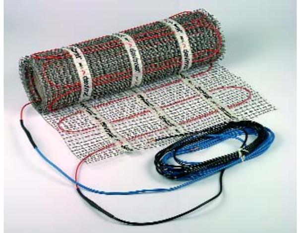
**devimat™ DTVF-100** (100 Вт/м<sup>2</sup>), **DTVF-150** (150 Вт/м<sup>2</sup>). Напряжение 230 В. Двухжильный, экранированный нагревательный кабель Ø 4,8 мм., закрепленный на самоклеющейся сетке шириной 45 см. Для установки в пол без формирования толстой цементной стяжки (в основном под плитку с плиточным клеем).
