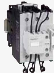
Трехполюсный контактор СТХ-С для устройств компенсации реактивной мощности на 70 квар/140 А, 230-250 В~/, 1Н.О.+1Н.З.
