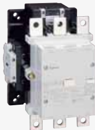
Трехполюсный контактор CTX-2 на 205 А, 230-250 В~/, 1Н.О.+1Н.З.
