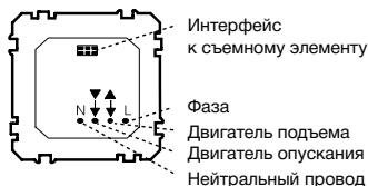
Стандартный механизм управления жалюзи (артикул MTN580698)
