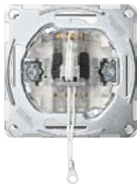
Механизм 1-полюсного кнопочного выключателя со шнурком, с замыкающим контактом и отдельным контактом сигнализации*
