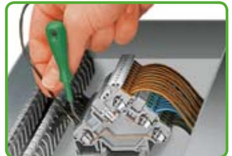
Указанные выше отвертки благодаря размерам лезвий согл. DIN 5264 особенно хорошо подходят для приведения в действие клемм с фронтальным монтажом для датчиков и исполнительных устройств серии 280.
