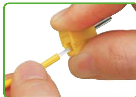
Подсоединение проводников: сожмите клемму со стороны прямоугольного отверстия и введите в него конец проводника со снятой изоляцией до упора.
