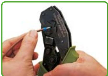
Введите проводник с надетым на него наконечником в обжимное отверстие и сжимайте рукоятки инструмента, пока не будет преодолено сопротивление фиксатора, препятствующего его преждевременному открыванию.
