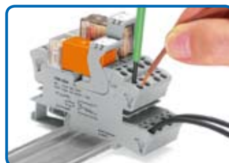
Одножильные проводники, копроволочные проводники с концевыми втулками или с ультразвуковым уплотнением концов жил: для подсоединения просто вставьте в отверстие клеммы.
