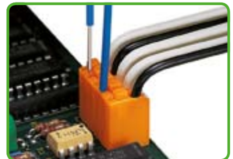
Измерение с помощью пробника Ø 1 мм/0,039 дюйма
