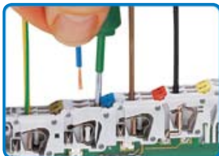
Вибропрочное, быстрое и не требующее обслуживания подсоединение проводников сечением от 28 - 14 AWG (0,08 - 2,5 мм 2 ).
