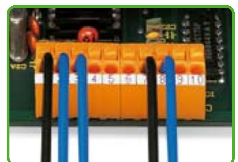
Нарращивание клеммных блоков в сборку без нарушения шага контактов в полюсах.
