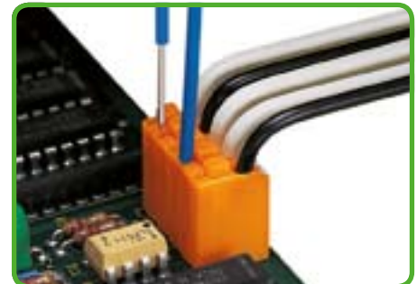
Измерение с помощью пробника Ø 1 мм/0,039 дюйма
