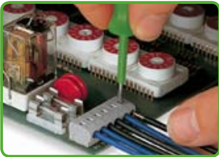
Отсоединение проводника без нажатия кнопки.
