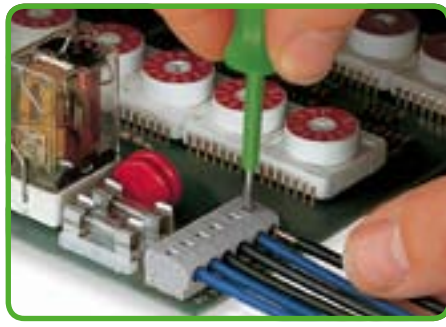
Просто вставьте проводник. Клеммы без нажимных кнопок.
