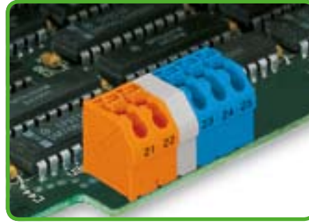
Маркировка самоклеющимися маркировочными полосками или путем непосредственной печати. Изоляционное покрытие клеммных колодок другими цветами с/без разделителя - по запросу.
