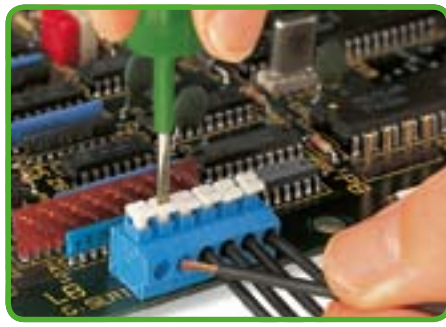
Подсоединение/отсоединение тонких многожильных проводников с помощью нажимных кнопок.
