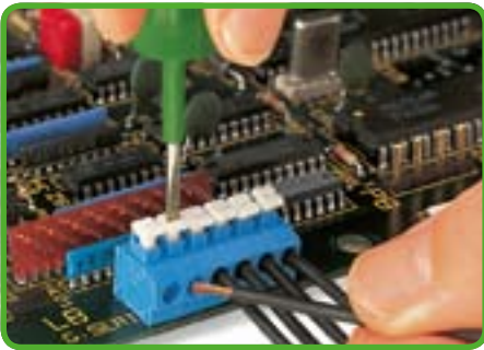
Подсоединение/отсоединение тонких многожильных проводников с помощью нажимных кнопок.
