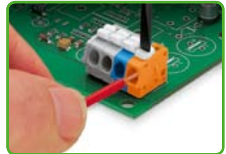
Подсоединение/отсоединение тонкопроволочных проводников: нажав кнопку фиксатора, откройте отверстие клеммы и введите в него проводник со снятой изоляцией до упора.
