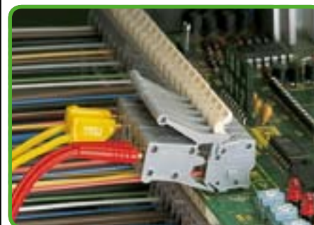
Измерение с помощью тестового адаптера.
