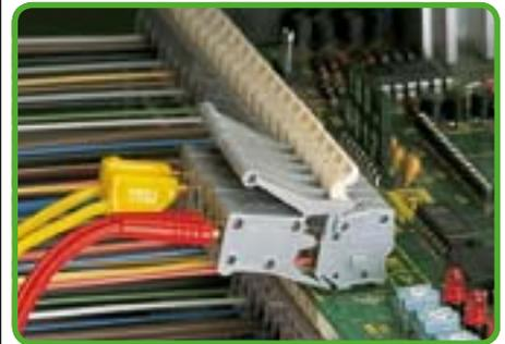
Измерение с помощью тестового адаптера.
