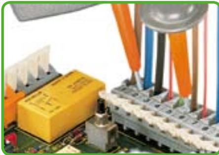
Измерение при помощи пробников.
