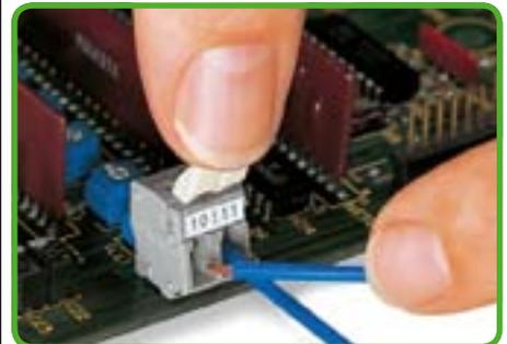
Подсоединение/отсоединение проводников, серия 257. Без инструмента. Клеммные колодки с нажимными кнопками, см. Полный каталог продукции, том 2.
