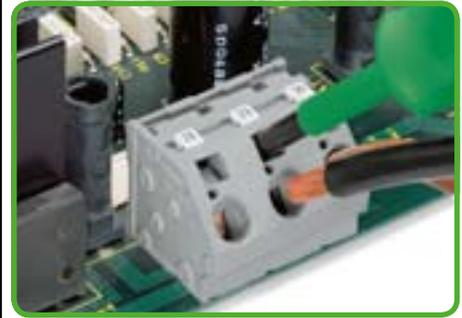
Зажим проводника при помощи отвертки 5,5 мм/ 0,21 дюйма.
