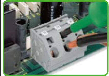
Зажим проводника при помощи отвертки 5,5 мм/ 0,21 дюйма.
