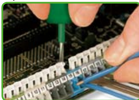
Подсоединение/отсоединение проводников, серия 256.
