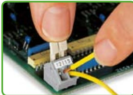
Подсоединение/отсоединение проводников, серия 256. Без инструмента. Клеммные колодки с нажимными кнопками, см. Полный каталог продукции, том 2.
