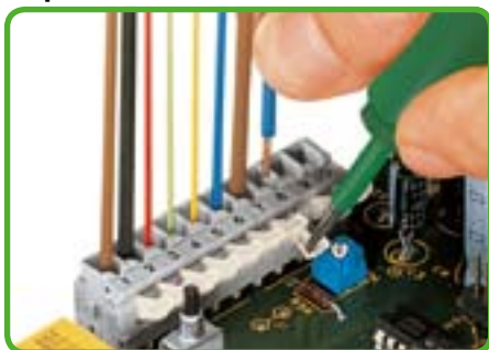
Подсоединение/отсоединение проводников, серия 255
