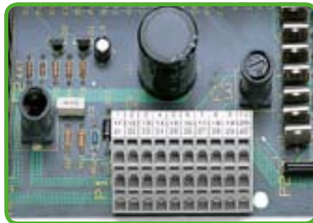
Экономия места благодаря 3-уровневой клеммной колодке.
