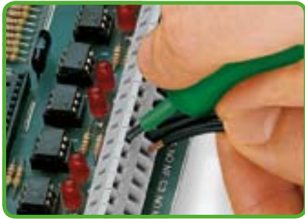
Зажим проводника при помощи отвертки 3,5 мм/ 0,137 дюйма: Ввод провода и работа с зажимом производятся параллельно друг другу.
