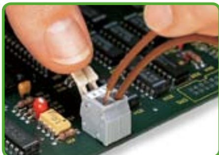
Подсоединение/отсоединение проводников, серия 255. Без инструмента. Клеммные колодки с нажимными кнопками, см. Полный каталог продукции, том 2.
