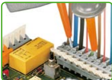
Измерение при помощи пробников.
