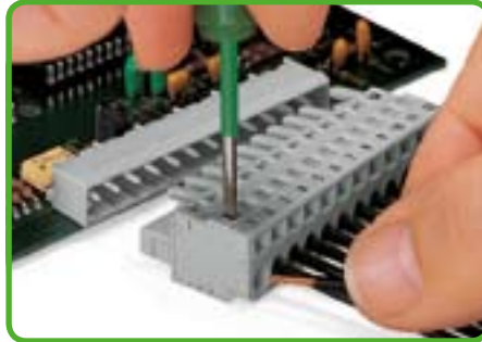
Зажим проводника при помощи отвертки 3,5 мм/ 0,137 дюйма: Ввод провода и работа с зажимом производятся перпендикулярно.
