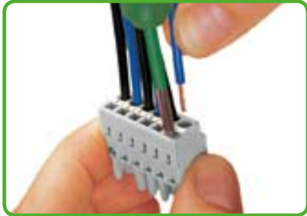
Зажим проводника при помощи отвертки 3,5 мм/ 0,137 дюйма: Ввод провода и работа с зажимом производятся параллельно.
