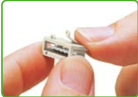
Кодировка вилки установкой кодировочных штифтов.
