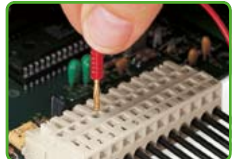
Проверка с помощью тестового штекера Ø 2 мм/0,079 дюйма или Ø 2,3 мм/0,091 дюйма.
