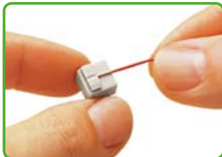
Одножильные проводники: изоляцию снять на длине 5 – 6 мм / 0,22 дюйма.
