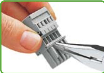
Кодировка розетки — выломайте кодировочные выступы. Первый и последний кодировочные выступы для фиксации не удаляйте или дополнительно используйте фиксатор.
