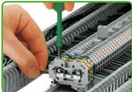
При помощи отвертки открутите отверстие клеммы и введите в него проводник со снятой изоляцией до упора.
