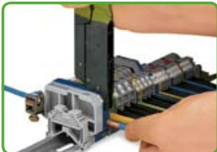
Неподвижную губку клеммных клещей вставьте в верхнее разжимное отверстие клеммы, затем навесьте подвижный их захват в боковое разжимное отверстие. Сожмите обе рукоятки до щелчка – отверстие клеммы полностью откроется. Введите проводник со снятой изоляцией до упора.
