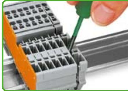
Откройте сборку при помощи отвертки (3,5 x 0,5) мм, сдвиньте клемму в сторону и извлеките через шлиц для демонтажа.
