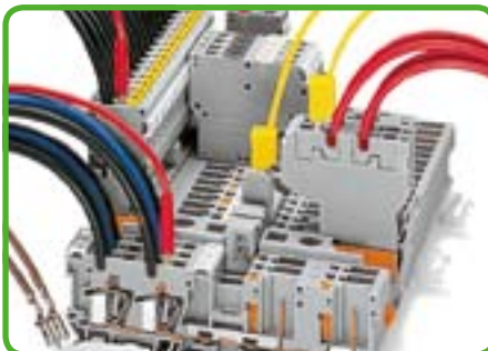
Проверка с помощью тестового штекера Ø 2 мм/0,079 дюйма (красный) или Ø 2,3 мм/0,091 дюйма (желтый).
