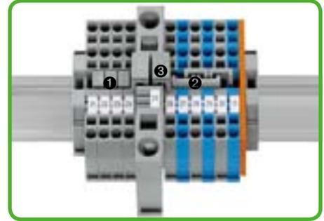
Объединение поперечными перемычками 1 или ступенчатыми перемычками 2. Объединение перемычками клемм под большое и малое сечение проводников 3.
