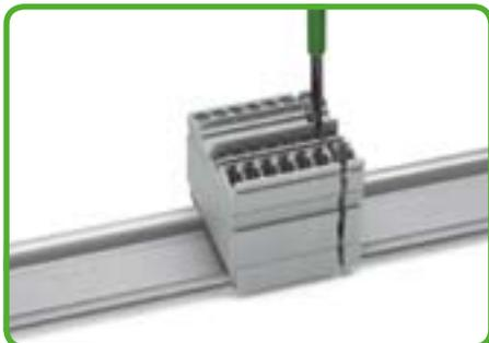
Откройте сборку при помощи отвертки (3,5 x 0,5) мм, сдвиньте клемму в сторону и выньте через шлиц для демонтажа.
