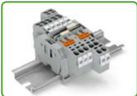
Два гнезда для перемычек в одном положении с другими клеммами серии 2002. Объединение перемычкой на выбор: перед ножевым размыкателем или за ним, в зависимости от стороны подачи питания. Два боковых и один центральный держатель маркировки для маркировочного профиля WMB или маркировочных полосок.
