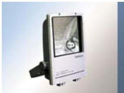
Высокоэффективные прожекторы с встроенными пускорегулирующими аппаратами (ПРА) с асимметричными мало слепящими световыми пучками, распределяемыми ниже горизонтальной плоскости. Для достижения хорошей цветопередачи в них применяются металлогалогенные лампы (МГЛ).
