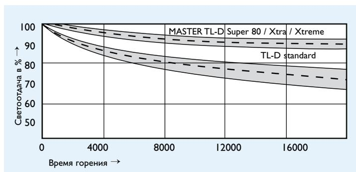
Стабильность светового потока лампы MASTER TL-D Super 80 по сравнению со стандартной лампой Т8
