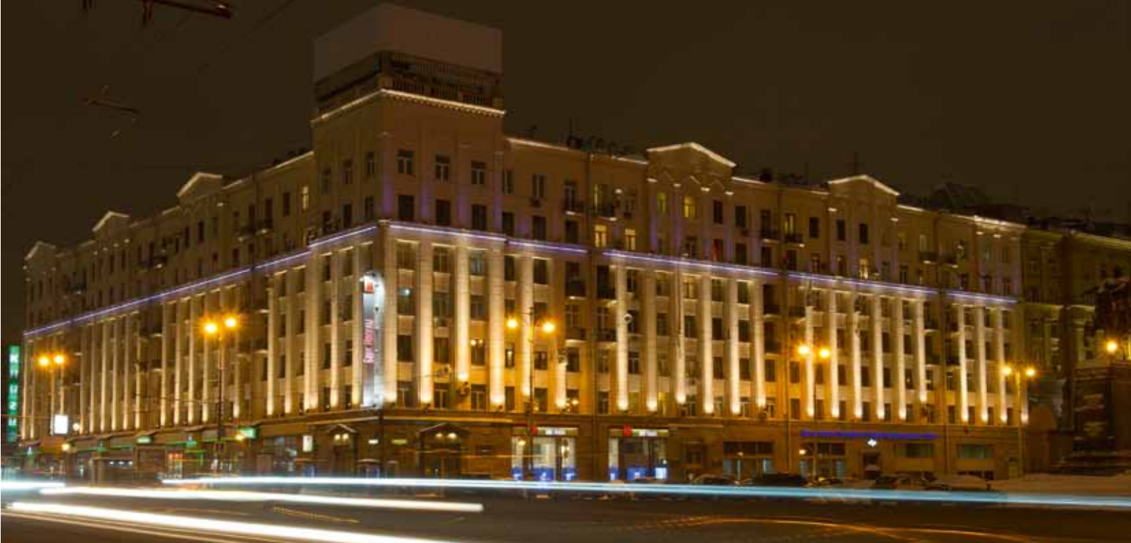
Установка 2. Установка с двух сторон от колонн
