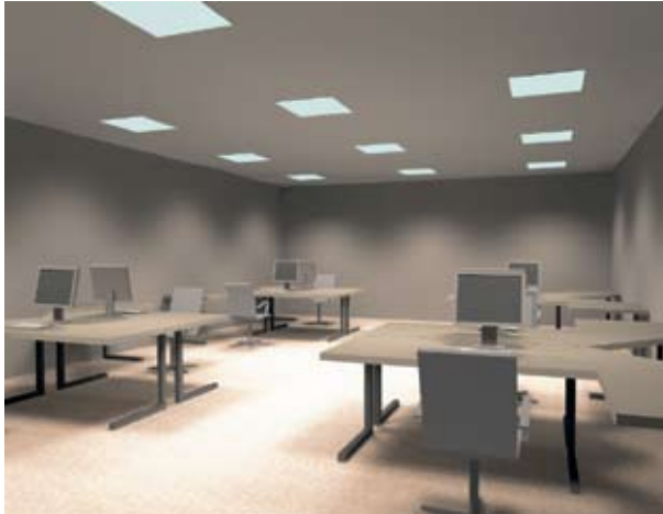
Рис. 2. Офис, освещенный с помощью приборов PRBLUX 418, расставленных полем UGR < 10 , E_{cp} = 463 лк, удельная мощность 15 Вт/м 2 .
