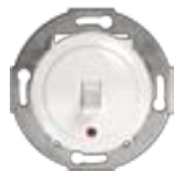
Переключатель скрытой установки однопрычажковый на два направления с индикатором Напряжение 250 В Ток 10-16 А Габариты 70 x 70 x 37 мм
