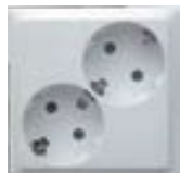
Розетка двойная скрытой установки с заземляющими контактами и защитными шторками
