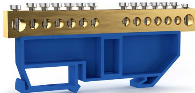
Крепление шины предусмотрено по центру через DIN изолятор на 35 мм монтажную DIN-рейку.
