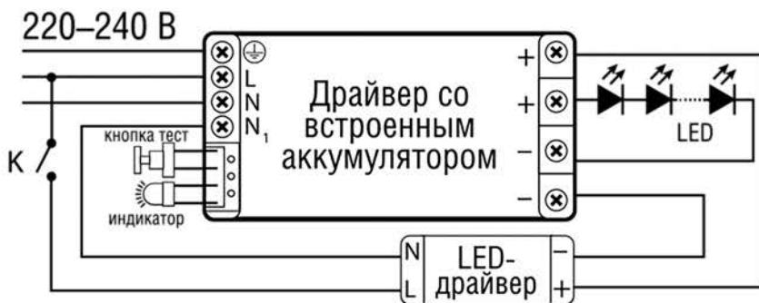
Схема подключения БАП в светильнике NLP-S2-A
