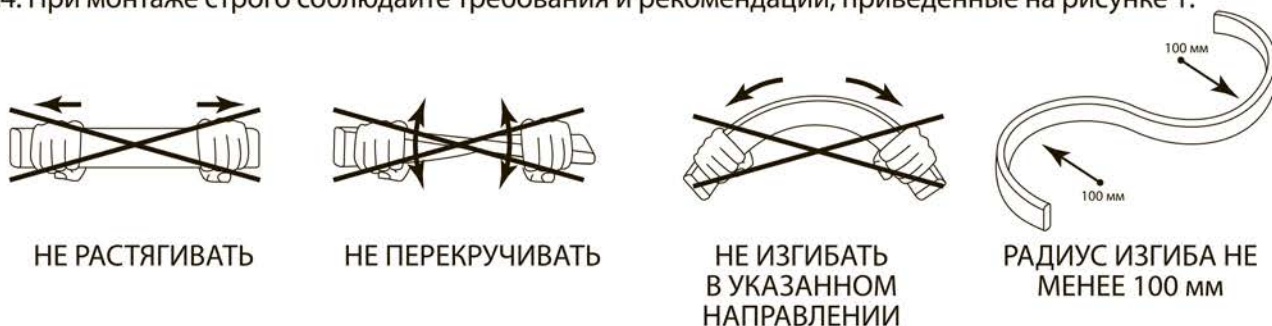
Рисунок 1. Требования и рекомендации для монтажа гибкого неона.
