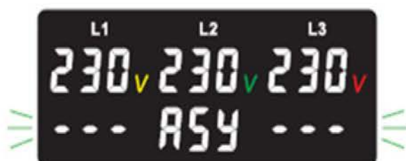
Рисунок 13. Внешний вид дисплея в случае асимметрии фаз
