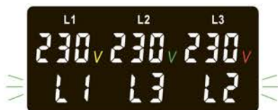
Рисунок 7. Внешний вид дисплея лицевой панели реле в случае неправильного порядка чередования фаз
