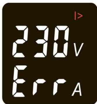
Рисунок 6. Внешний вид дисплея лицевой панели реле после подачи питающего напряжения
