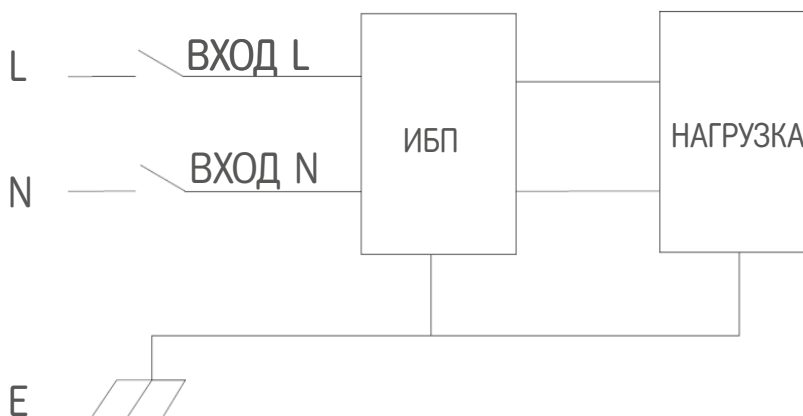
Рис. 3-3 Схема соединения на входе – «одна фаза + земля»
