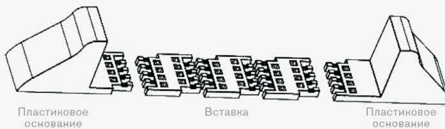
Рис. 5-1(б) Подставка для ИБП совместно с батарейным кабинетом
