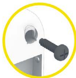
Крепление крышки с помощью самореза Fastening the cover with a self-tapping screw
