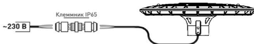
Рис.1. Схема подключения светильника к сети 230В.
