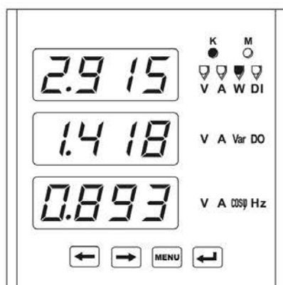
c) diSP 3. Отображение активной мощности, реактивной мощности, \cos\mu / diSP 3. Display of active power, reactive power, \cos\mu
