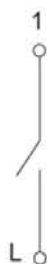
а) выключатель одноклавишный / 1-gang switch / бір пернелі ажыратқыш/ intrerupator singură / bitta klavishli viklyuchatel
