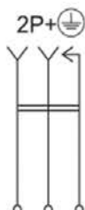
b) одноместная с заземлением / single with grounding / жерге қосылатын жалғыз / single cu împământare / topraklama bilan bitta
