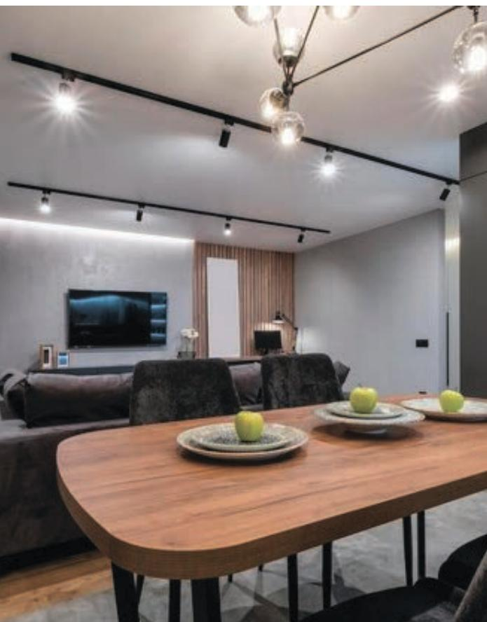
Шинопровод CAB1007 для установки 1-фазных трековых светильников отличается повышенной жесткостью профиля и наличием пространства для прокладки кабеля. Токоведущие жилы выполнены из меди и имеют плоскую форму для лучшего соприкосновения со светильником, нагрузка составляет до 16А (порядка 3500Вт).
