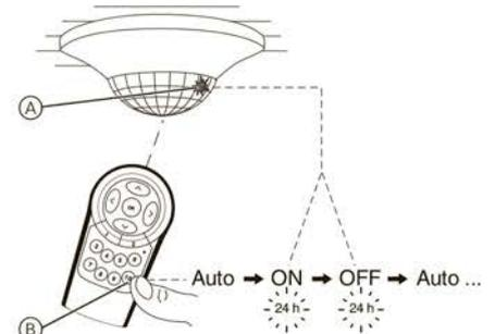
• Функция «Авто»: Сенсорный модуль работает в автоматическом режиме, включает нагрузки при детектировании движения и выключает их после истечения времени задержки.
