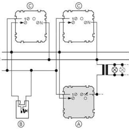
**i** В случае подключения дополнительного TELE-механизма требуется нулевой провод.
