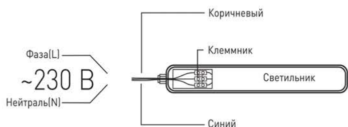
Рис.1. Схема подключения светильника к сети 230В.
