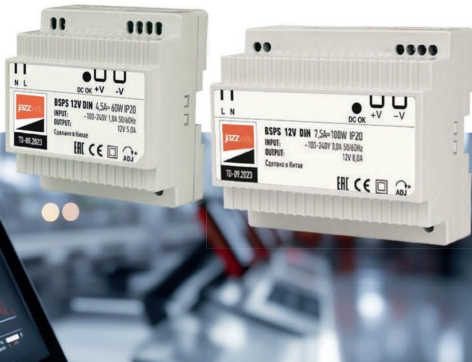
Блок питания **BSPS 12V** поставляется в пластмассовом корпусе с креплением на DIN-рейку и предназначен для преобразования входного переменного напряжения 100–240 В в постоянное стабилизированное напряжение 12 В. Имеет защиту от перегрузки, превышения выходного напряжения и короткого замыкания на выходе. Используется для питания светодиодного и промышленного оборудования.
