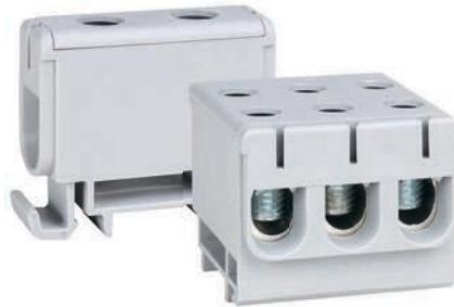
Клеммы вводные силовые серии OptiClip KBC используются в качестве вводных и распределительных клемм при сборке НКУ. Основное назначение — элемент переходного соединения алюминиевых и медных проводов со специальной подготовкой от 6 до 95 мм<sup>2</sup>, а также в качестве дополнительного элемента для подключения и установки промышленного оборудования в цепях переменного или постоянного тока до 800 В.
