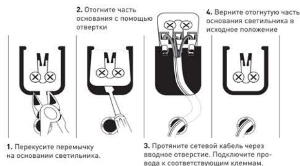
Рис.2. Схема подключения светильника SP0-7-40 к сети 230В.
