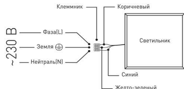
Рис.1. Схема подключения светильника SP0-6-36-...-А (с коннектором для БАП). SP0-6-48 и SP0-6-72 к сети 230В.
