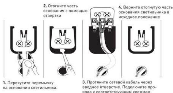
Рис.2. Схема подключения светильника SP0-6-36 (без коннектора для БАП) к сети 230В.
