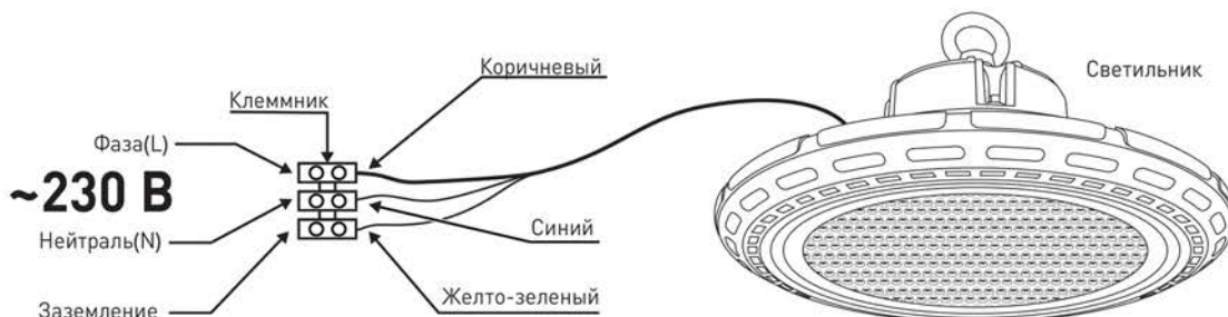
Рис.1. Схема подключения светильника к сети 230В.
