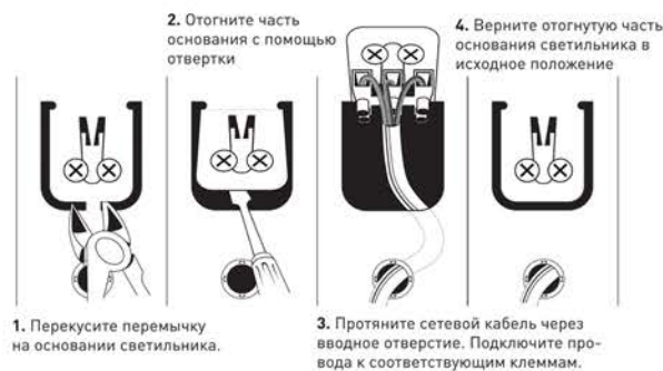
Рис.2. Схема подключения светильника SPO-6-36 (без клеммника для БАП) к сети 230В.
