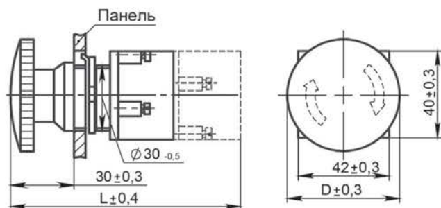
Рисунок А.2 – Габаритные размеры выключателей с грибовидным толкателем
