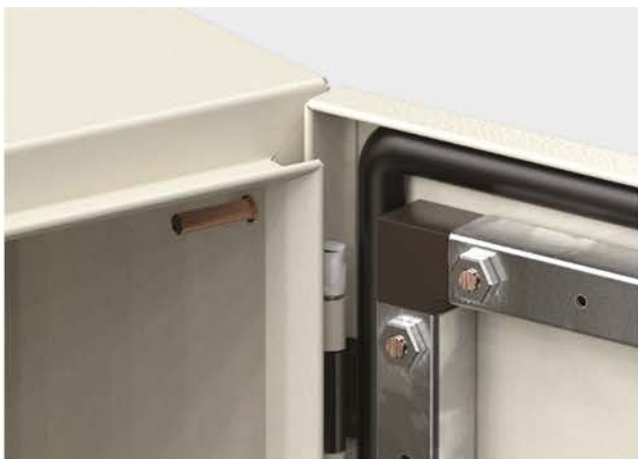
Двойная заковка по периметру оболочки и двери увеличивает жесткость конструкции, сохраняет геометрию корпуса
