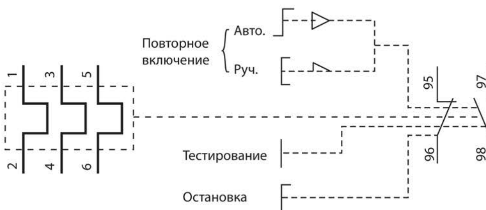
Рисунок 5. Схема электрическая принципиальная реле
