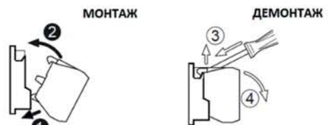
Монтаж и демонтаж контактного блока
