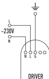
Сетевой провод «Ноль» (**N**) подключить к контакту блока питания **N** (синий).
