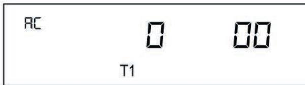
Разряд 1 - запрет/разрешение перехода на сезонное время: 0 - переход запрещен; 1 - переход разрешен
