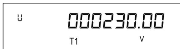
Среднеквадратическое значение напряжения на параллельной цепи счётчика, в В
