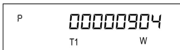
Мощность нагрузки в Вт
